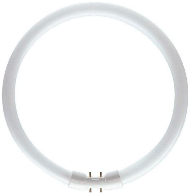
Esta lámpara TL5 circular (diámetro de tubo de 16 mm) ofrece posibilidades de diseño ampliadas. El tubo fino permite crear luminarias extremadamente planas y permite la distribución de luz omnidireccional. Es adecuada para una amplia gama de aplicaciones profesionales y semiprofesionales y es ideal para su uso en tiendas, oficinas y zonas públicas con diseños no convencionales.
